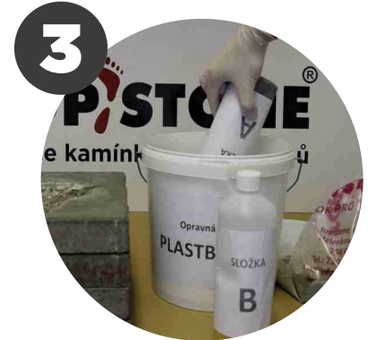
Nalijeme složku A a složku B do kbelíku a důkladně promícháme přiloženým dřevěným míchadlem (cca 3minuty)
